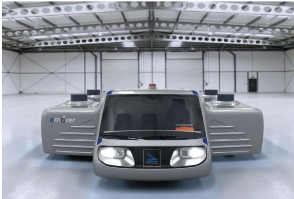
Abbildung 1: Der emover - ein beispielloses Multitalent für emissionsfreies Schleppen und Manövrieren von Flugzeugen
